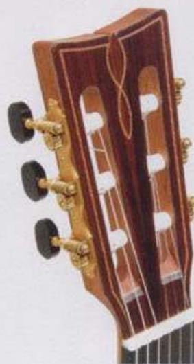
Des filets décoratifs ornent le contour de la pièce en palissandre des Indes plaquée sur la tête, dont la forme n'est pas sans rappeler celle des Panormo. Notez que les mortaises sont carrées.
